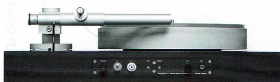
写真左側、ベース天板からアームの付け根へ接続されているチューブは、アームの横スライド時の摩擦を軽減しスムーズなトラッキング動作を助けるためのエア供給路。アーム後端から延びるリード線にはアームの上下左右への動きを妨げないよう極めて細い高品質銅リップ線が用いられ、RCA端子による出力部(XLRやDIN端子も選択可能)へと接続されている。端子部右側にはアームとターンテーブルへ圧搾空気を送り込むパイプの接続口とDC12Vの駆動用電源の入力端子が並ぶ。
