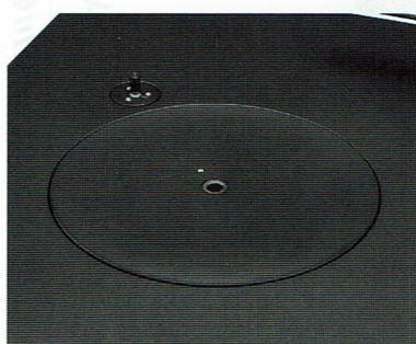
写真中央、ターンテーブル用スピンドル受けの横に見える小さな孔が、ブラッターをフローティングさせるための圧搾空気の噴出孔。ブラッターとベースの隙間に空気層によるエアペーリングを形成し、二重構造を持つ総重量7kgのブラッターをベースから浮かせることで、摩擦抵抗を極限まで低減させる。左上にDCサーボモーターのドライブブリーダーが見える。
