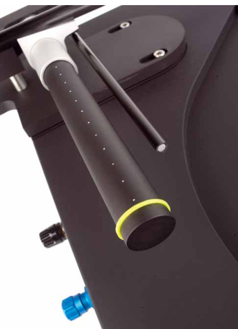
Über diese Bohrungen strömt die Luft aus, die den Tonarm in der Schwebe hält
