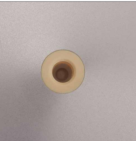
Die Kunststoffbuchse im Teller bildet das Gegenstück zur Tellerachse und muss nur horizontale Kräfte aufnehmen
