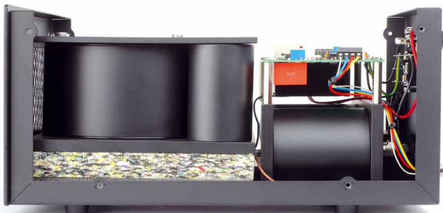
Im gut bedämpften Inneren des Speiseteils werden Druckluft und Betriebsspannungen erzeugt
